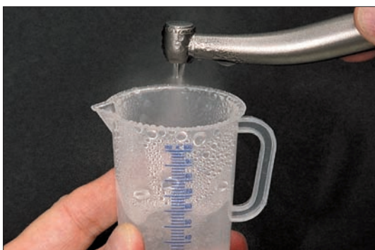
Проверка минимального количества охлаждающей жидкости (50 ml в минуту) Check the water coolant flow with a minimum of 50 ml per minute.
